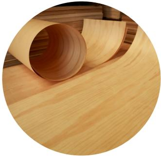
**ШПОН** – это древесный отделочный материал в виде пластинок или листов толщиной не более 3 мм. Для его изготовления используется около двухсот видов деревьев, включая редкие породы.
